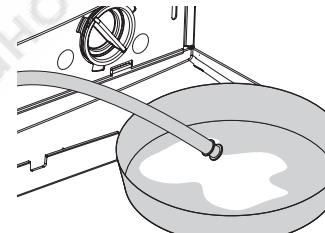
конце шланга. Если объем воды превышает емкость контейнера, закройте шланг пробкой, слейте воду из емкости, после чего возобновите процесс слива.
