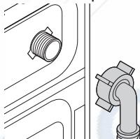
подсоединения к водопроводному крану и к машине. Прямой конец шланга с фильтром следует подсоединить к крану, а изогнутый
