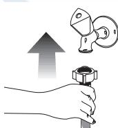
конец шланга - к машине. Хорошо затяните гайки на шланге рукой; никогда не пользуйтесь для этого гаечным ключом.
