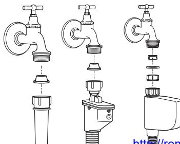
предотвращает попадание в машину посторонних веществ и грязи из воды. По мере загрязнения фильтры следует очищать.
